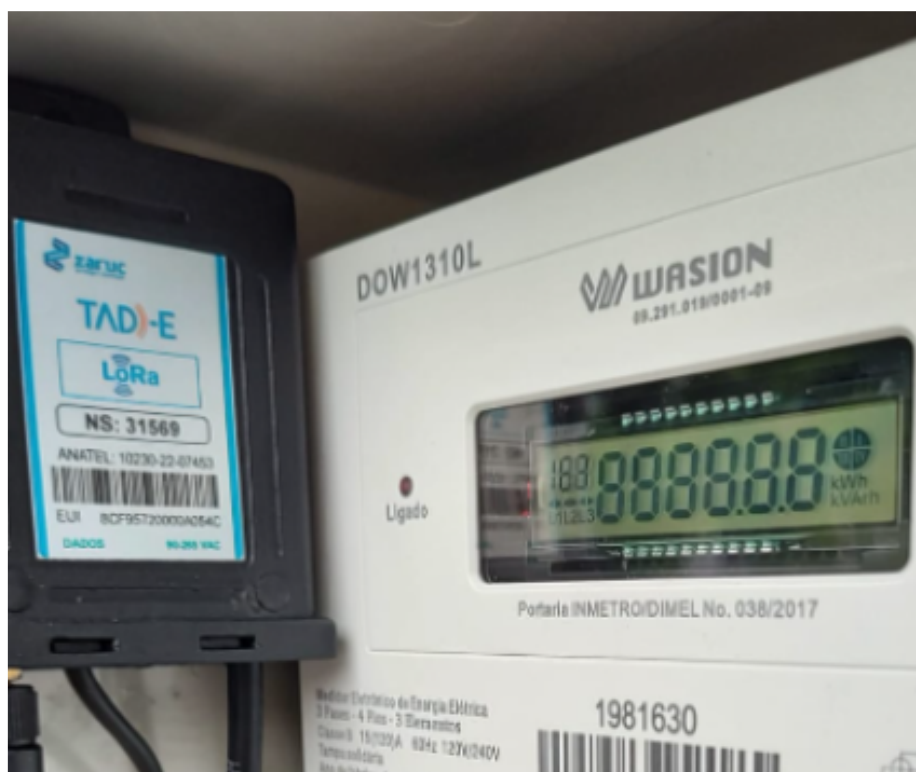
Figura 6 - Exemplo de medidor com dispositivo instalado.
